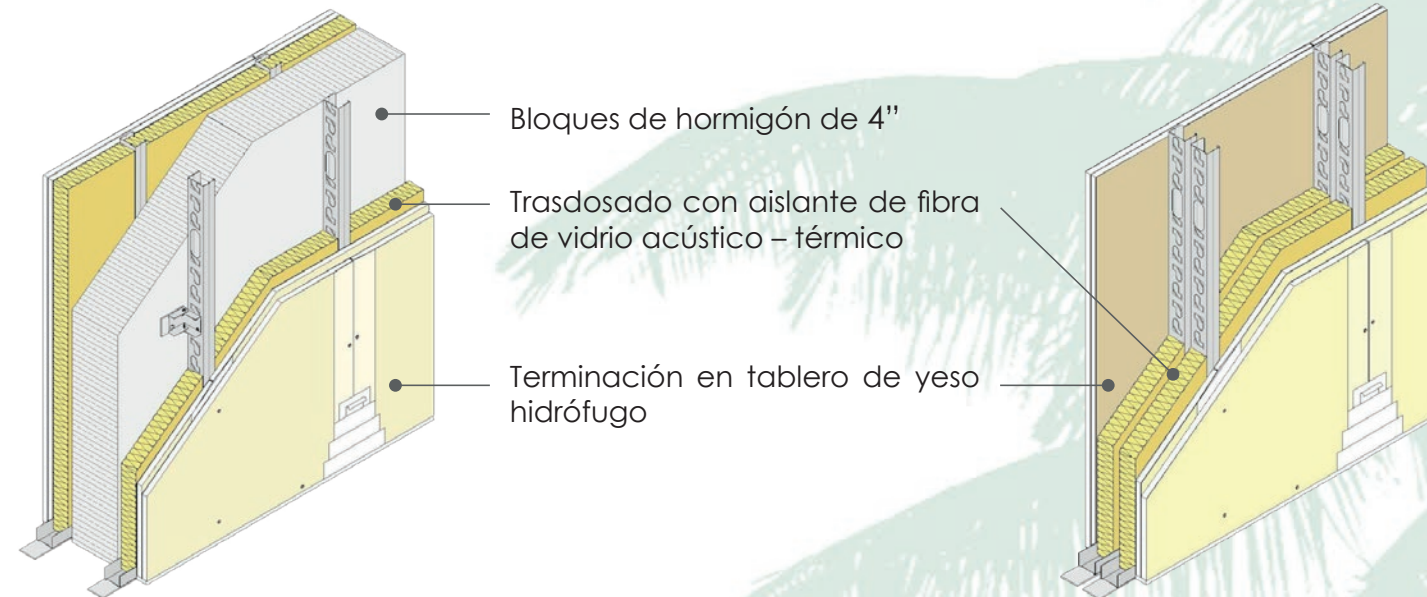
Tabique medianero entre apartamentos
